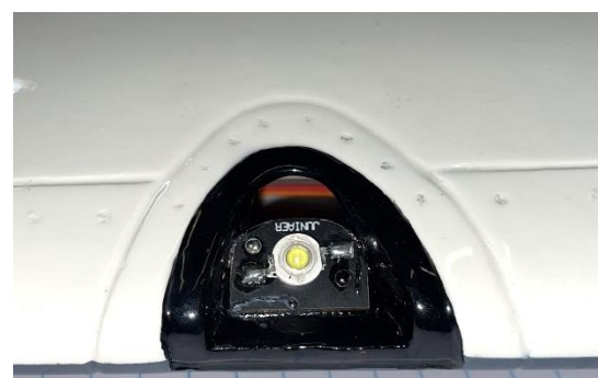
Above: locais corretos de fixação das placas de luz de ponta de asa (left) e faróis (right).
