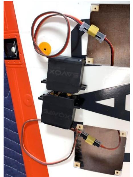
Acima: Processo de passagem dos fios e extensões na asa (esquerda) e servos conectados com travas (direita).
