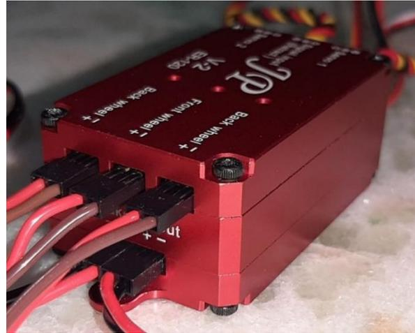
Acima: controladora JP ER-150 V2 com freios mostrando as conexões dos retrâteis no lado superior e saídas dos freios no lado inferior. Note a polaridade correta dos fios como escrito no gabinete da controladora.
