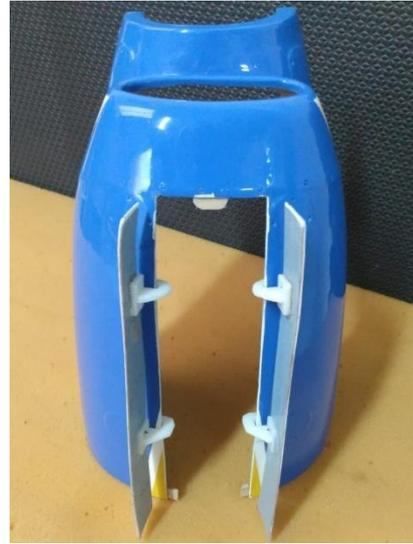
Acima: fixadas com dobradiças de portas e compartimentos, as duas portas dianteiras do trem de pouso dianteiro na carenagem inferior do motor.
