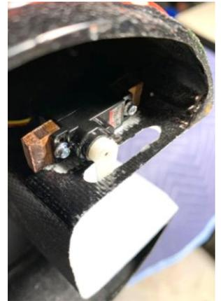
Acima: as 2 portas traseiras do trem de pouso dianteiro em posição final (esquerda), horn instalado na porta traseira do trem de pouso dianteiro (centro) e local de fixação do micro servo (direita).
