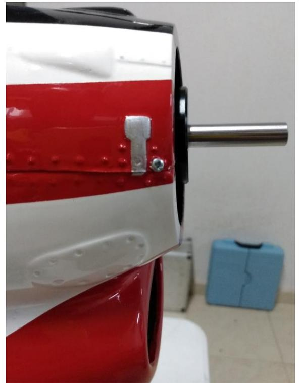
Acima: alinhamento paralelo spinner/carenagem (esquerda) e eixo do motor/carenagem (direita).
