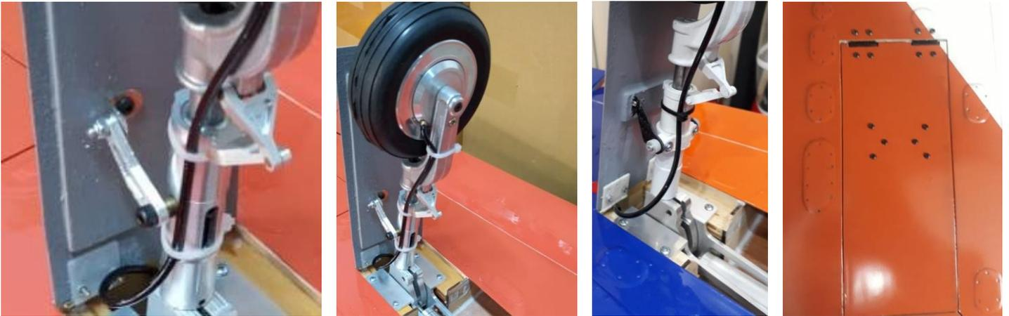
Acima: detalhe da fixação dos suportes articulados à porta externa do trem de pouso externa e porta de trem de pouso externa fechada.
