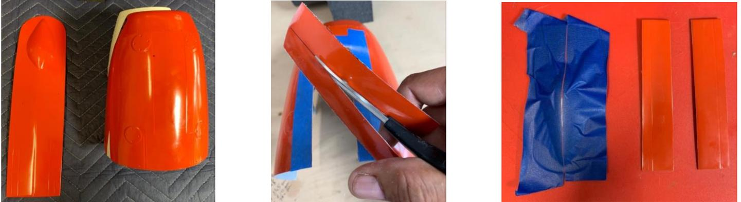
Acima: processo de corte da carenagem inferior do motor e das 4 portas do trem de pouso dianteiro.
