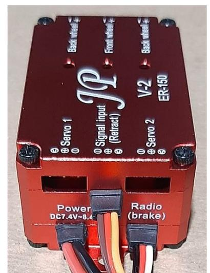
Acima: controladora JP ER-150 V2 com freios mostrando conexões dos retráteis no lado superior e saídas de freios no lado inferior (foto esquerda). Plugues JST (macho e fêmea) e os 2 plugues servo padrão de 3 vias para sinal de retração e freio (centro). O fio de alimentação (vermelho e preto) retrai o fio do sinal de rádio (amarelo, vermelho e marrom), o fio do sinal de rádio dos freios (vermelho, preto e branco) e as conexões dos servos das portas de trem de pouso (foto à direita).
