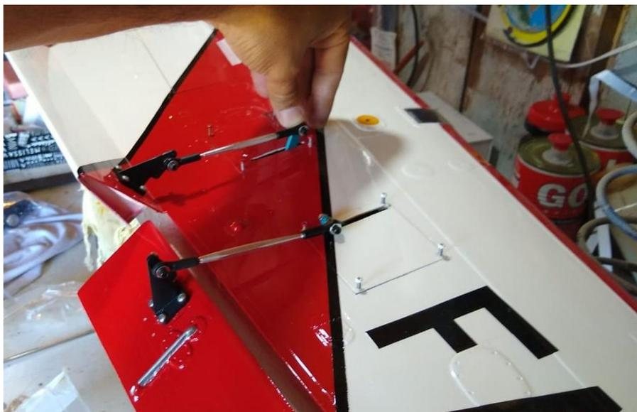
Acima: posição dos servos, braços de servos e horns de comando dos ailerons e flaps.
