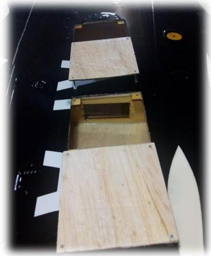
Acima: localização das tampas de acesso aos servos dos ailerons e flaps e nervuras para fixação.
