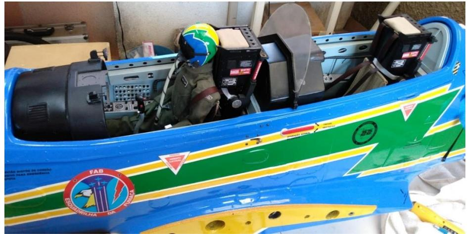
Acima: frames internos da moldura do canopy instalados (esquerda) e todas as partes do cockpit (cockpit frontal, cockpit traseiro, divisor de cockpit, parte traseira e frames da moldura instaladas (direita).
