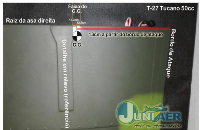
Notas: os aeromodelos com pintura artística que exigem maiores sobreposições de tintas e adesivos apresentam maior peso total. No caso de motorização elétrica não é necessário acrescentar peso para obter o correto balanceamento do C.G., e a posição das baterias de Li-Po deve ser definida ao final da montagem. No caso de motorização à gasolina o balanceamento é mais delicado, sendo necessário posicionar baterias e módulo de ignição junto a parede de fogo pelo lado interno da fuselagem.
