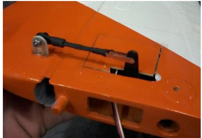
Acima: posição do servo, braço de servo, horn e comando do profundor.
