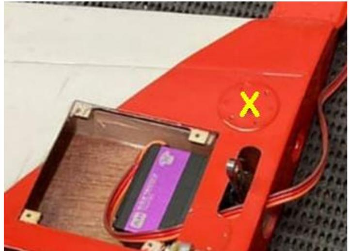
Acima: posição do tubo na metade do estabilizador e fuselagem (esquerda) e detalhe do local do furo (indicado com a letra X amarela) para fixação das metades do estabilizador no tubo do estabilizador (direita).
