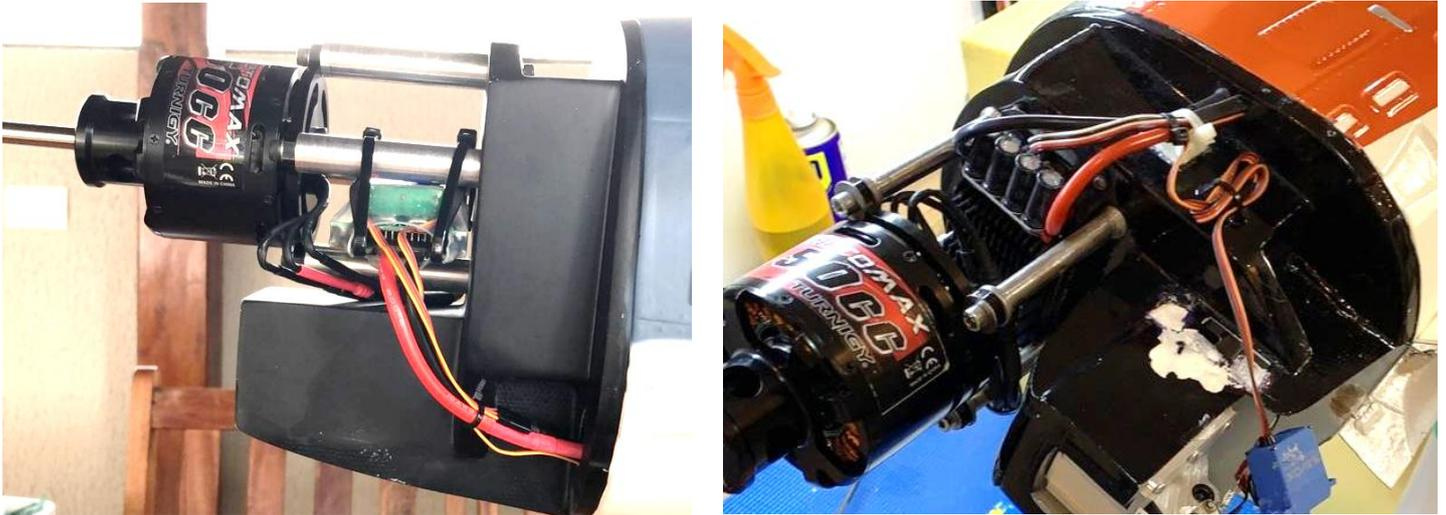
Acima: instalação de motor elétrico e speed control na posição horizontal (esquerda) e vertical (direita).
