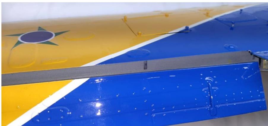
Acima: áreas em cinza (bordos de fuga) não devem ser perfuradas ou cortadas. Flaps e ailerons.
