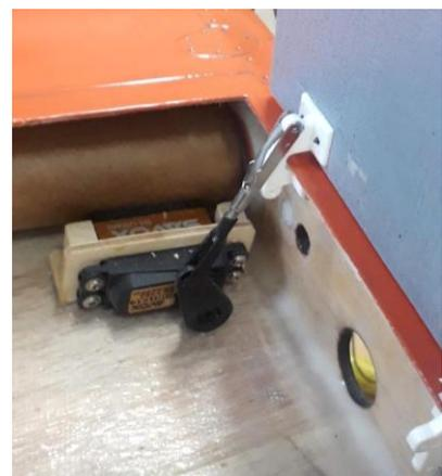
Acima: dobradiças de portas de compartimento e micro servo instalado com lincagem.
