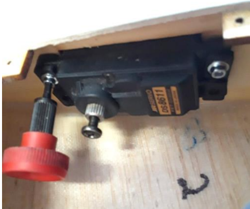
Acima: chave e posição correta para parafusar os servos da asa
