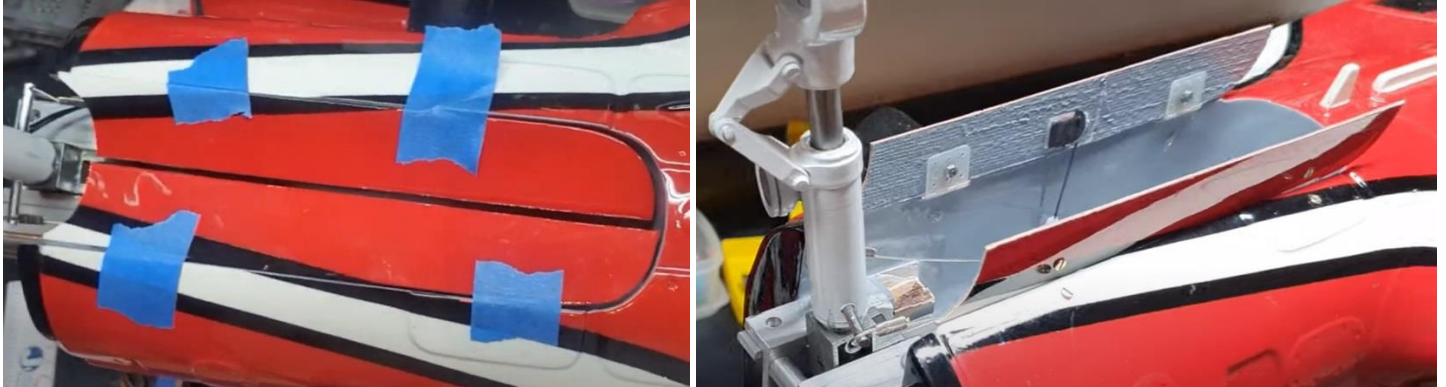
Acima: Posicionamento das portas dianteiras na fuselagem (esquerda) e instalação completa das 2 portas dianteiras com horn de comando para abertura e fechamento (direita).
