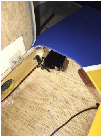
Acima: Dobradiças Dubro instaladas na porta interna e posição do micro servo
