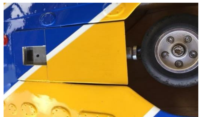
Acima: Detalhe da fixação da porta externa dividida em 2 partes com suportes no strut do retrátil.
