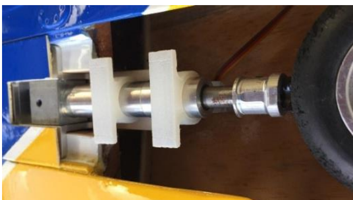
Acima: Detalhe da fixação da porta externa dividida em 2 partes com suportes no strut do retrátil.
