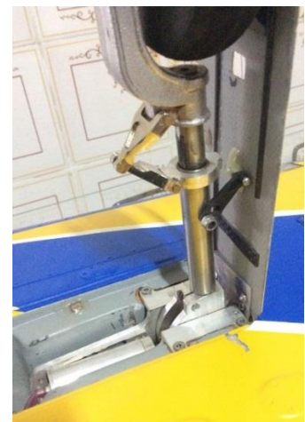
Acima: Detalhe da fixação dos suportes articulados à porta externa do trem de pouso externa e porta de trem de pouso externa fechada.
