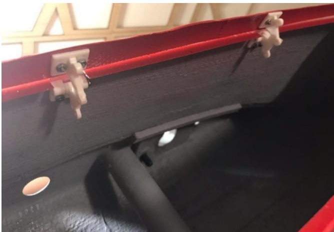
Acima: conjunto canopy/moldura com dobradiças internas.
