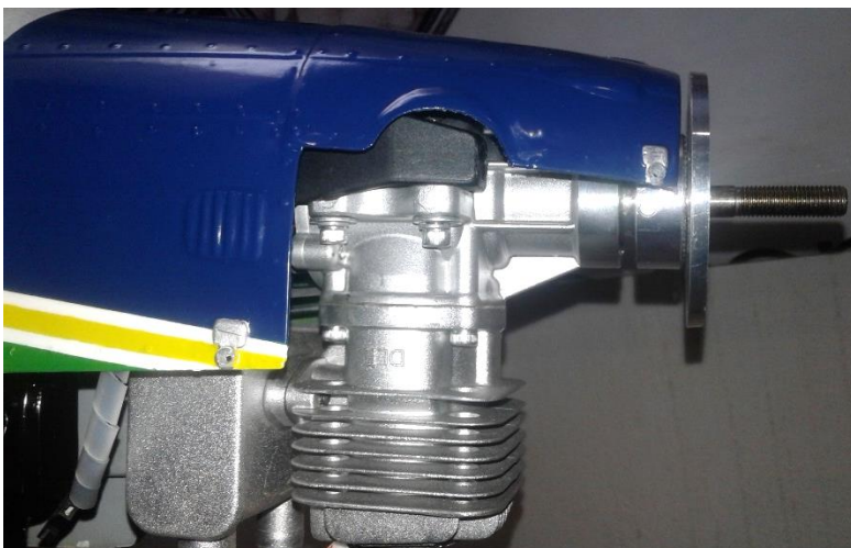
Acima: instalação da parte superior (esquerda) da carenagem do motor e ambas com alinhamento (direita).
