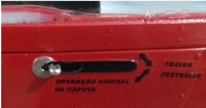
Acima: Posição da trava do conjunto canopy/moldura na fuselagem.
