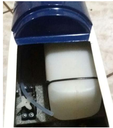
Acima: posição típica do tanque (esquerda) e servo do acelerador com tanque deslocado para a direita (centro). Abastecedores de alumínio (direita).
