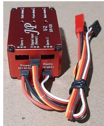
Acima: Controladora JP ER-120 V2 com controles do freio e saídas para os retráteis (esquerda) e fios para alimentação, sinal de rádio e conexões para servos de portas de trem de pouso (direita).
