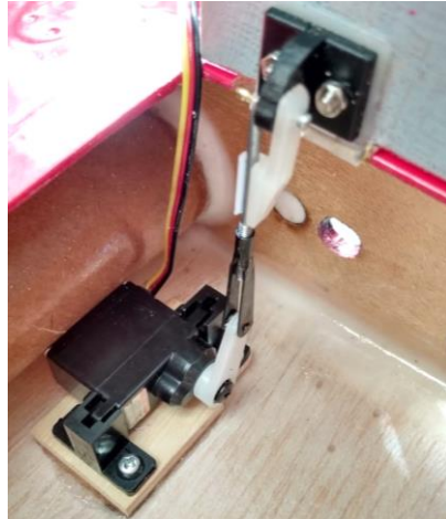
Acima: Micro servo instalado com lincagem e horn para atuação do mecanismo.
