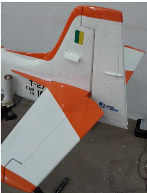
Acima: estabilizador e leme na posição definitiva (esquerda) e horns do leme e profundor (direita).
