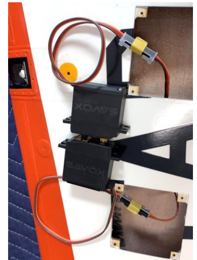
Acima: processo de passagem dos fios e extensões na asa (esquerda) e servos conectados com travas (direita).
