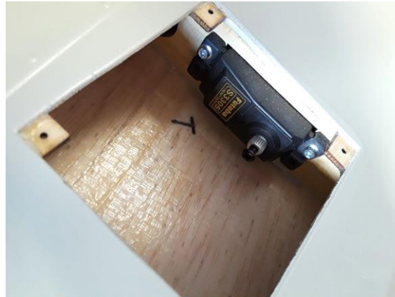
Acima: chave e posição correta para parafusar os servos da asa
