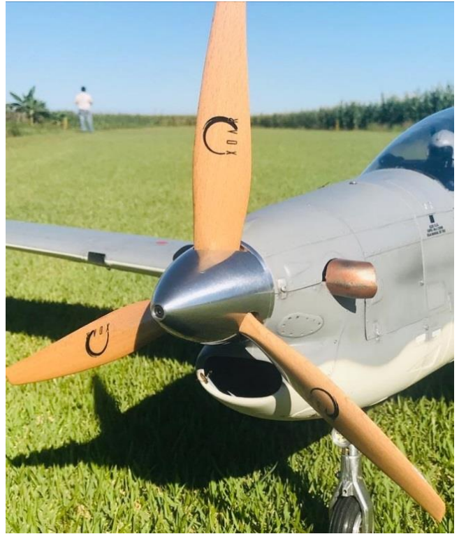
Acima: alinhamento paralelo spinner/carenagem.
