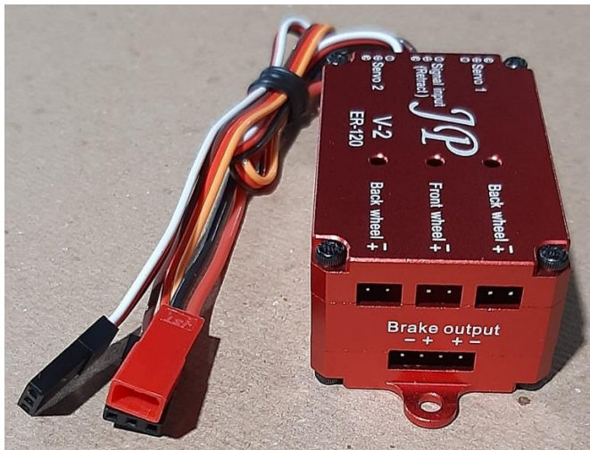
Acima: Controladora JP ER-120 V2 com controles do freio e saídas para os retráteis (esquerda) e fios para alimentação, sinal de rádio e conexões para servos de portas de trem de pouso (direita).
