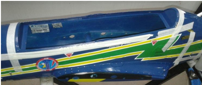
Acima: posição da moldura do canopy na fuselagem e fixação no local com fita adesiva em todo seu contorno.
