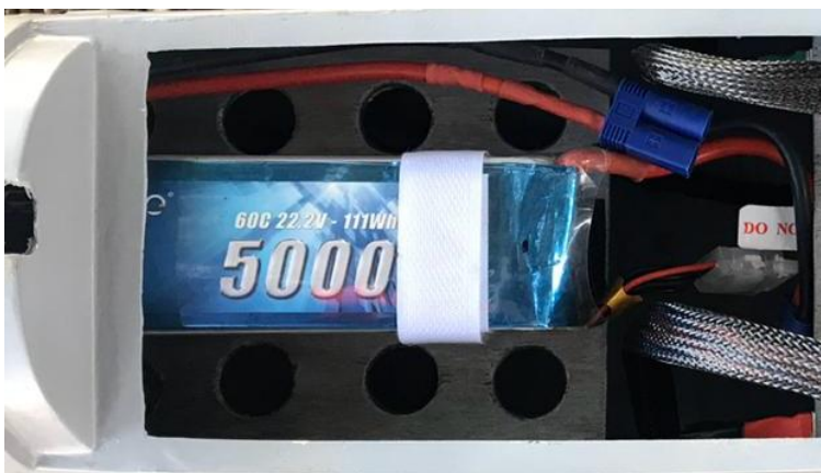
Acima: posição das baterias de Li-Po utilizadas na versão com motorização elétrica. Definir posição definitiva após correto balanceamento do C.G.
