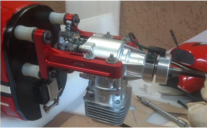
Acima: instalação do motor DLE-20RA em montante de alumínio com espaçadores anti-vibração.
