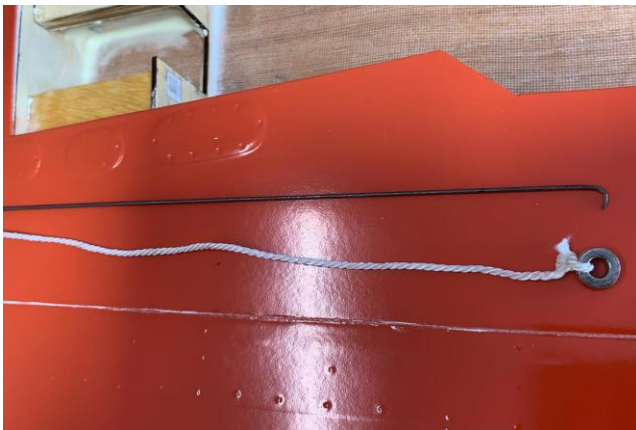
Acima: Corda com peso para passar os fios e arame para puxar as placas dos faróis da asa (esquerda).
