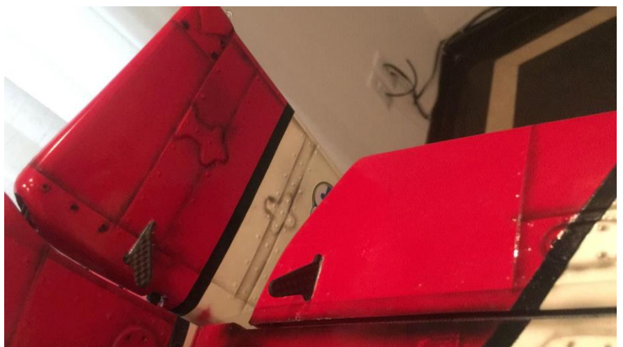
Acima: estabilizador e leme na posição definitiva (esquerda) e horns do leme e profundor (direita).
