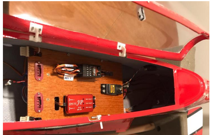
Acima: conjunto canopy/moldura com dobradiças internas.
