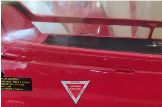
Acima: conjunto canopy/moldura com dobradiças Dubro DUB 116 externas.
