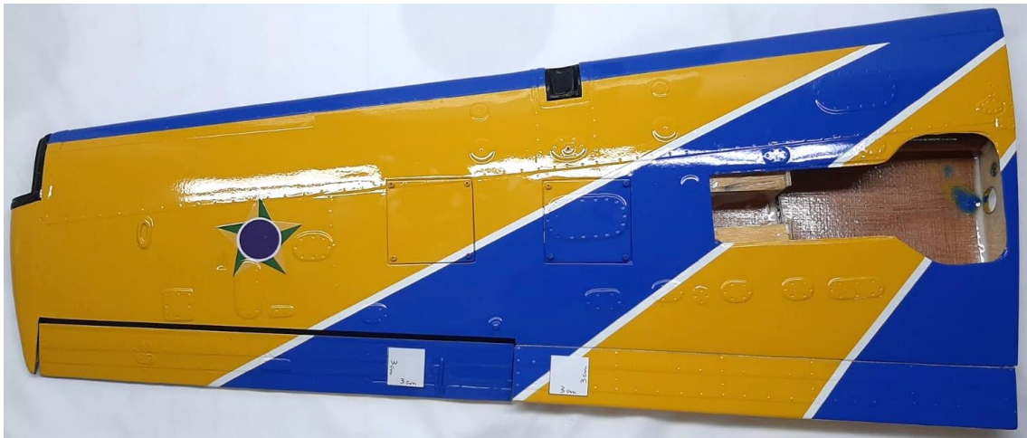
Acima: meia asa direita com localização das tampas dos compartimentos de servos e locais dos reforços para horns (30mm x 30mm) no aileron e flap marcados em branco.
