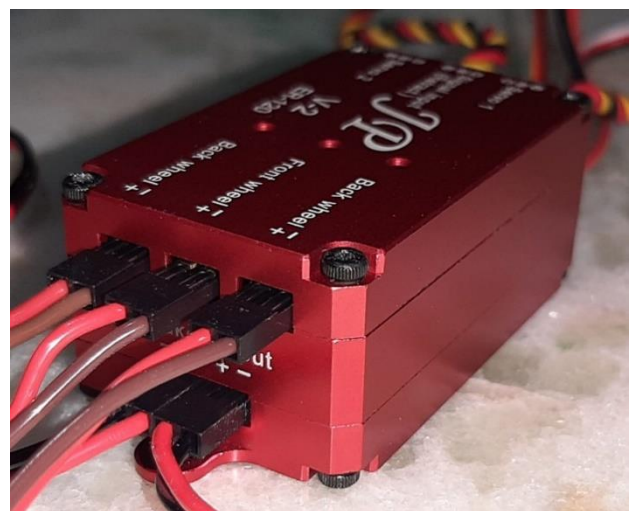
Acima: Controladora JP ER-120 V2 com freios mostrando conexões de retrateis no lado superior e saídas de freios no lado inferior. Observe a polaridade correta dos fios conforme escrito na caixa da controladora.
