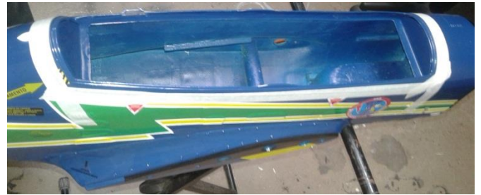
Acima: posição da moldura do canopy na fuselagem e fixação no local com fita adesiva em todo seu contorno.
