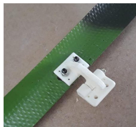
Acima: Fixação das dobradiças internas para abertura lateral do canopy.
