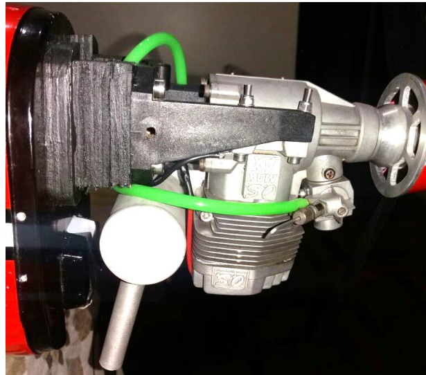
Acima: instalação de motor OS 95AX com escape tipo pitts invertido.
