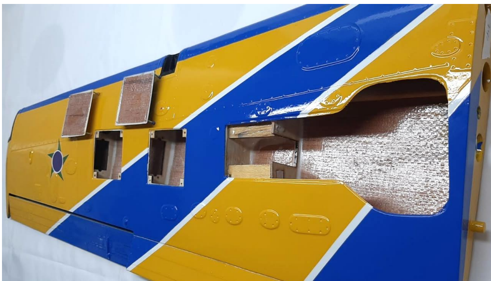
Acima: meia asa direita com tampas dos compartimentos de servos de aileron e flap abertas evidenciando locais para fixação dos servos nas nervuras.
