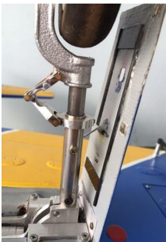
Acima: Detalhe da fixação dos suportes articulados à porta externa do trem de pouso externa e porta de trem de pouso externa fechada.
