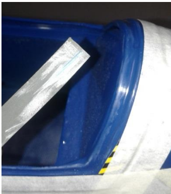
Acima: lixar a área de contato da moldura para aumentar a adesão da cola (esquerda) e aplicar cola branca em toda a área de contato (direita).
