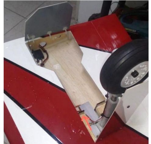
Acima: Dobradiças de portas de compartimento e micro servo instalado com lincagem.
