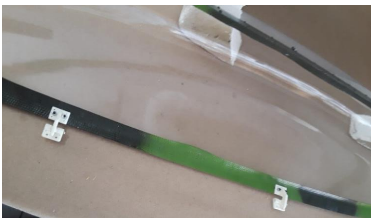
Acima: Fixação das dobradiças internas para abertura lateral do canopy.
