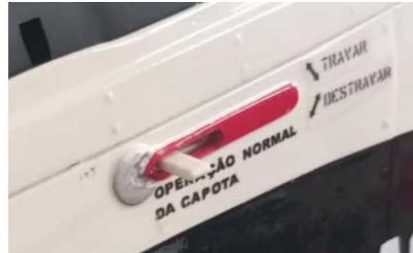
Acima: Posição da trava do conjunto canopy/moldura na fuselagem.
