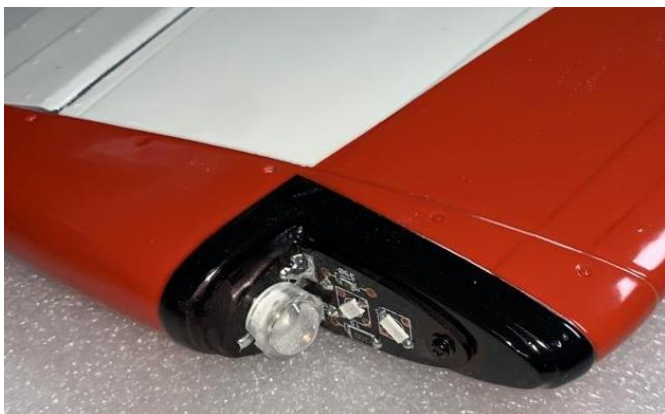
Acima: Locais corretos de fixação das placas de luz de ponta de asa (esquerda) e faróis (direita).
