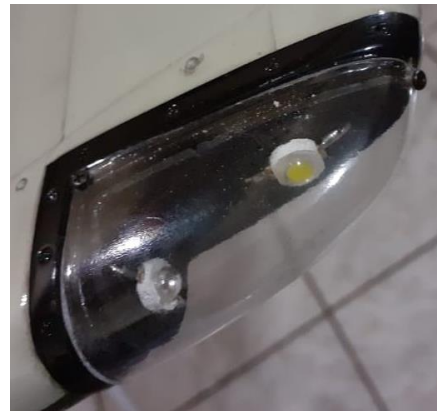
Acima: Peças plásticas transparentes devidamente coladas nos locais corretos.
