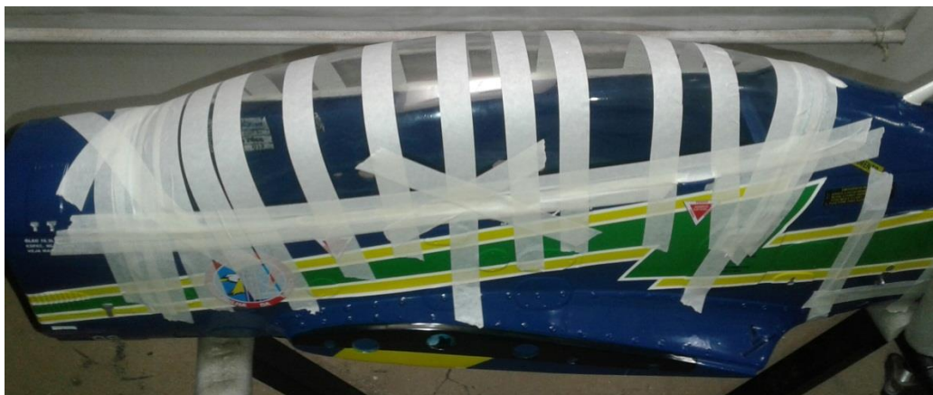
Acima: posição do canopy na moldura e fixação no local com fita adesiva em todo o seu contorno e também verticalmente, a fim de obter a posição correta entre as 3 peças.
