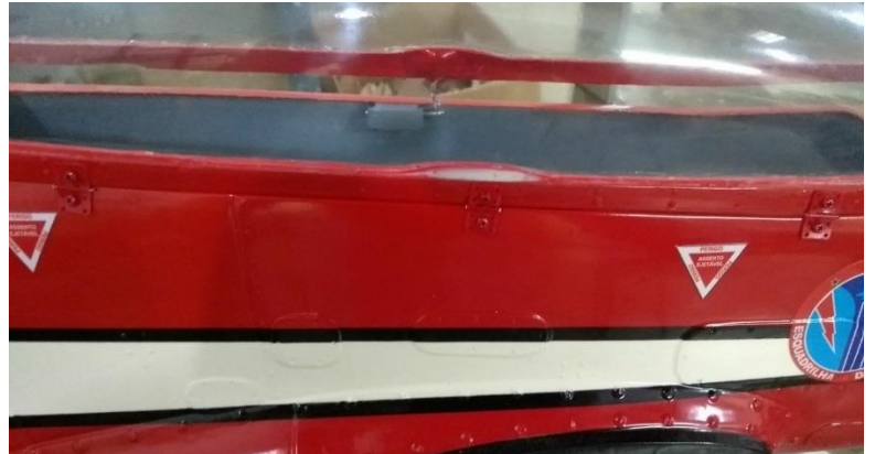
Acima: conjunto canopy/moldura com dobradiças Dubro DUB 116 externas.
