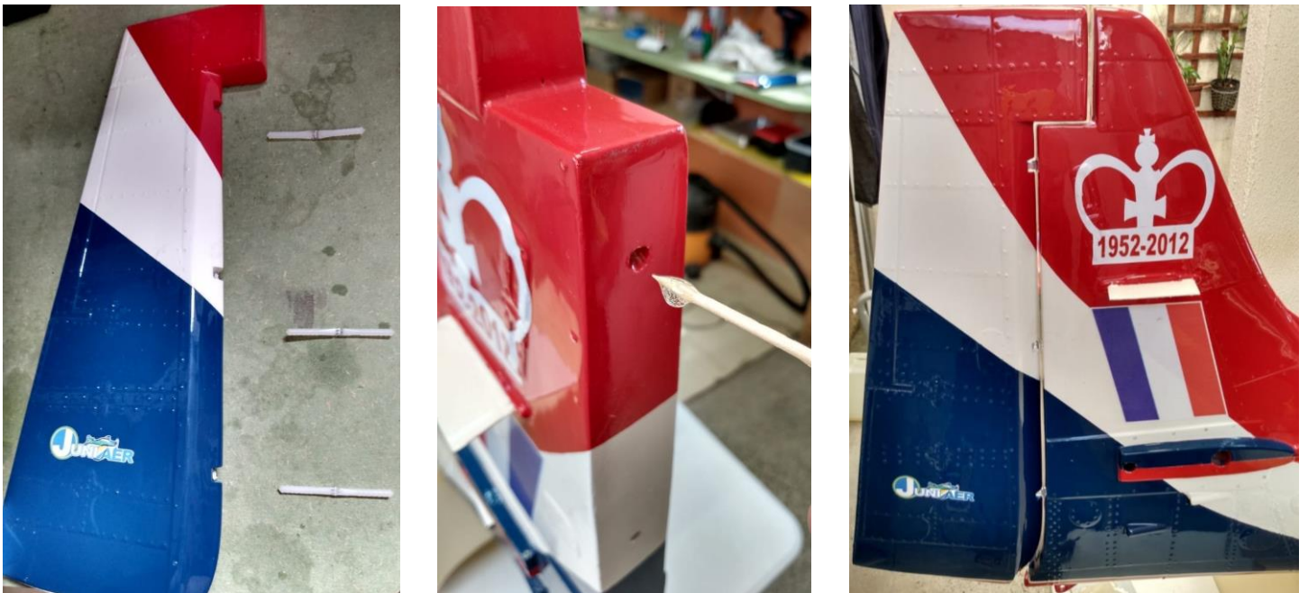
Acima: sequência de colagem das dobradiças do leme com cola epoxy.
