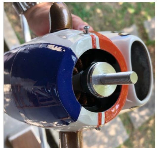
Acima: instalação da parte superior (esquerda) da carenagem do motor e ambas com alinhamento (direita).
