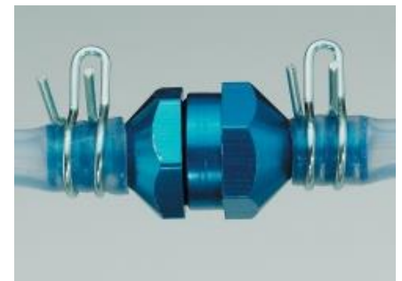
Acima: conexões internas do tanque de combustível (esquerda), clips de segurança para as conexões para motorização a gasolina (centro) e filtro de combustível com clips de segurança nas conexões (direita).
