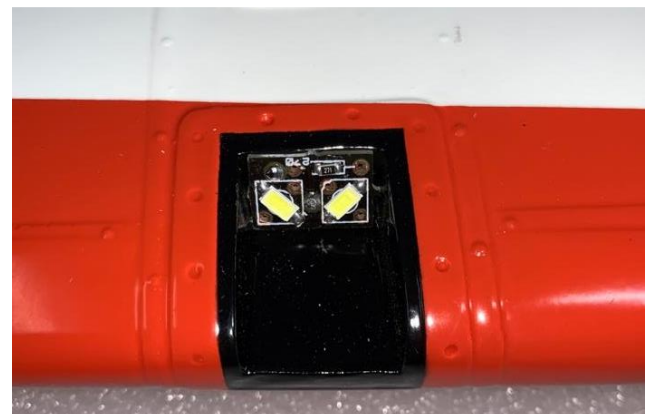
Acima: Locais corretos de fixação das placas de luz de ponta de asa (esquerda) e faróis (direita).
