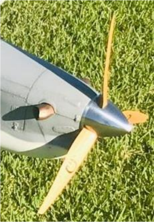
Acima: alinhamento paralelo spinner/carenagem.
