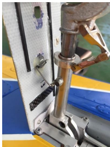
Acima: Detalhe da fixação dos suportes articulados à porta externa do trem de pouso externa e porta de trem de pouso externa fechada.
