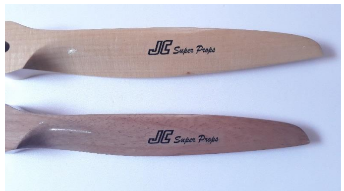
Acima: hélices bipá de madeira para motores a gasolina 20cc 14x10 ou 15x8.
