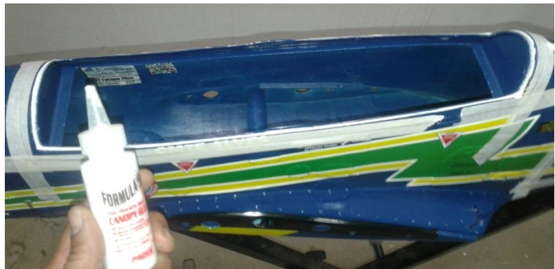
Acima: lixar a área de contato da moldura para aumentar a adesão da cola (esquerda) e aplicar cola branca em toda a área de contato (direita).
