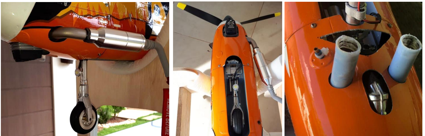
Acima: instalação da parte inferior da carenagem com motor glow 120 4 tempos (esquerda e centro) e com motor DLE-20RA com saídas de escape e ventilação (direita).
