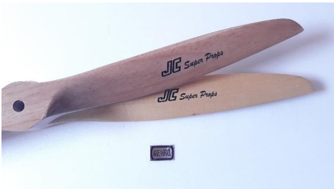
Acima: hélices bipá de madeira para motores a gasolina 20cc 14x10 ou 15x8.
