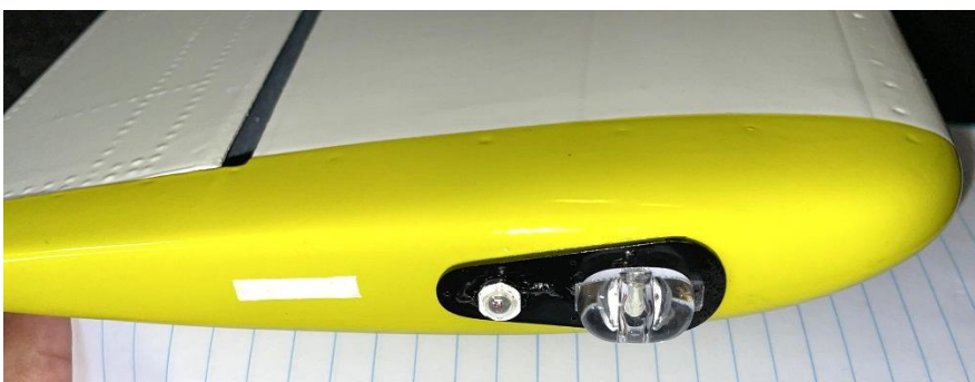
Above: locais corretos de fixação das placas de luz de ponta de asa (left) e faróis (right).
