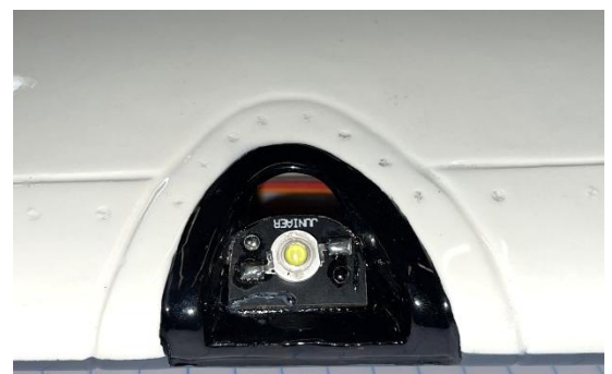
Above: locais corretos de fixação das placas de luz de ponta de asa (left) e faróis (right).
